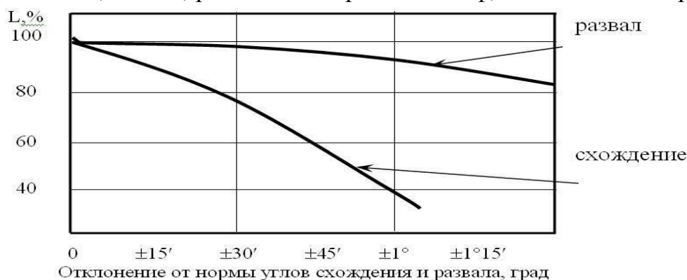
Рис. 3. Влияние углов установки колес на ресурс шины
