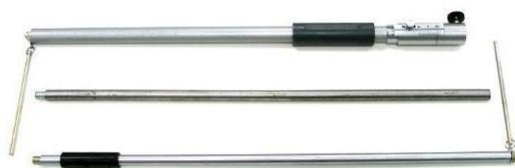
Рис. 4. Линейка для проверки угла схождения управляемых колес
